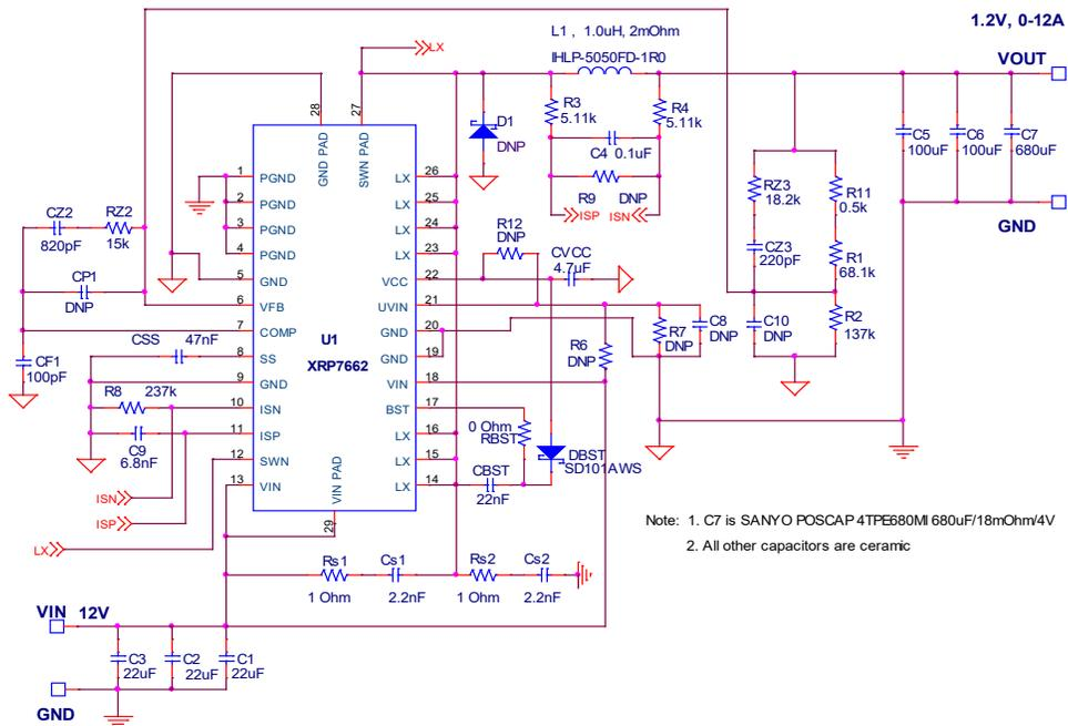
Fig. 17: 12V<sub>IN</sub> test circuit
