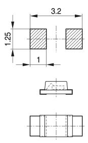
Bauteil positioniert Component location on pad OHFP2578
