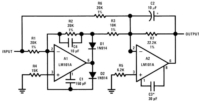
Figure 42. Fast AC/DC Converter<sup>(1)</sup>
