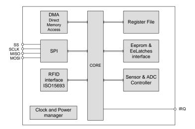
13.56MHZ SENSOR TAG / DATALOGGER IC
