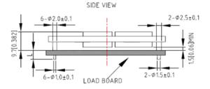
UNIT: mm[inch] BOTTOM VIEW: pin on upside TOLERANCE: X.Xmm±0.5mm[X.X in.±0.02in.] X.XXmm±0.25mm[X.XX in.±0.01in.]
